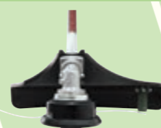
Le système "Tap & Go" permet de réajuster automatiquement le fil lors de l'utilisation en frappant la tête faucheuse au sol
