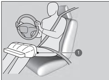
Lorsque l'airbag avant côté conducteur se déploie, l'airbag de genoux côté conducteur se déploie également.
