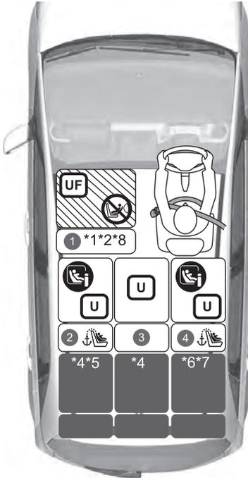
Airbag passager désactivé pour modèle à conduite à droite
