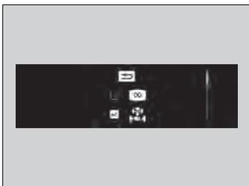
3. Tourner la molette de sélection gauche pour faire défiler les icônes, puis appuyer dessus pour les sélectionner ou les désélectionner.
