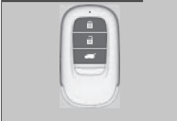
Utiliser les clés pour démarrer et arrêter le moteur, ainsi que pour verrouiller et déverrouiller toutes les portes, le coffre et la trappe à carburant.
