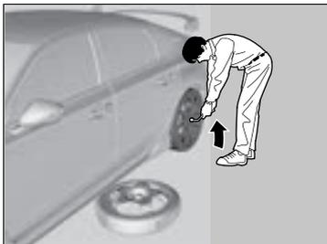
7. Desserrer chaque boulon de roue d'un tour environ à l'aide de la clé de boulon de roue.
