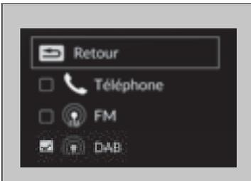
3. Tourner la molette de sélection gauche pour faire défiler les sources audio, puis appuyer dessus pour les sélectionner ou les désélectionner.
