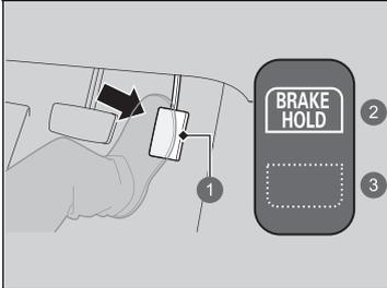
Appuyer sur la pédale d'accélérateur lorsque la transmission est dans une position différente de **P** ou **N**. Le système se désengage et le véhicule reprend sa route.
