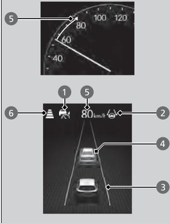
4 Indique si un véhicule situé à l'avant est détecté.
