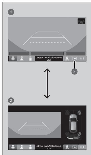
Il est possible d'activer ou de désactiver l'affichage fractionné en appuyant sur l'onglet de l'écran fractionné.
