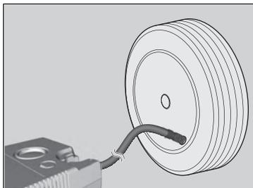
4. Contrôler de nouveau la pression d'air à l'aide de la jauge du compresseur d'air.
