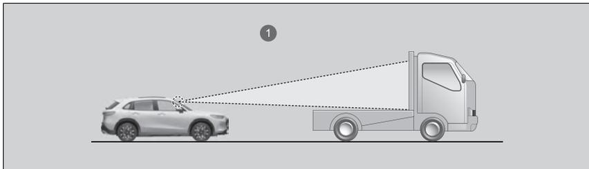
① La caméra grand angle avant détecte la partie supérieure d'un chariot porteur vide.
