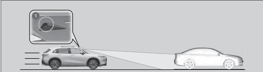
1 La caméra grand angle avant se situe derrière le rétroviseur.
