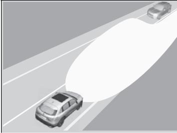
Lors de la conduite de nuit, la caméra grand angle avant détecte des sources lumineuses telles que les lampadaires ou les feux d'un véhicule venant en sens inverse/qui précède. En fonction de la situation, le système bascule automatiquement entre feux de croisement et feux de route.
