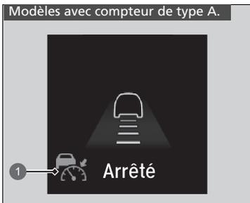
Si aucun véhicule ne vous précède avant de reprendre la conduite, appuyez sur la pédale d'accélérateur réactivera l'ACC avec maintien de distance de sécurité à basse vitesse selon la vitesse réglée précédemment.
