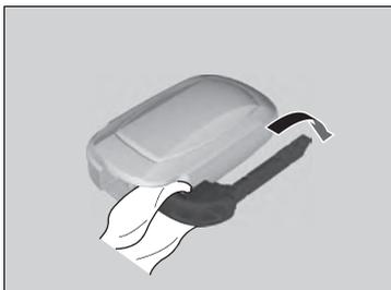
2. A l'aide d'un embout de clé, faire lever sur l'ouverture et déposer le demi-boîtier supérieur.
