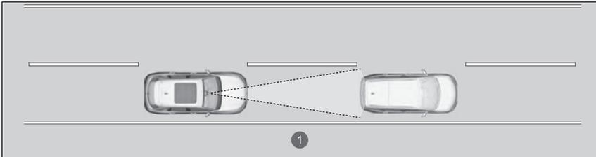
① Champ de détection de l'ACC avec maintien de distance de sécurité à basse vitesse : 120 m
