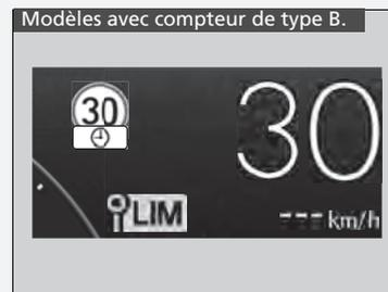
■ La fonction de limitation de vitesse peut passer en mode pause s'il n'y a pas de panneau de signalisation de limite de vitesse sur l'écran du système de reconnaissance des panneaux de signalisation lorsque :
