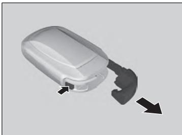
Type de pile : Pile lithium-dioxyde de manganèse CR2032
