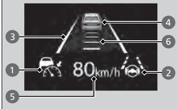
Il est possible de voir l'état actuel du régulateur de vitesse adaptatif (ACC) avec maintien de distance de sécurité à basse vitesse, du système d'assistance au maintien dans la voie de circulation (LKAS) et de l'assistance embouteillages.
