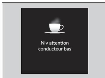
Lorsque l'option **Niv. attention conducteur** est sélectionnée sur l'interface d'information du conducteur, des barres s'allument en blanc pour indiquer le degré d'attention du conducteur.
