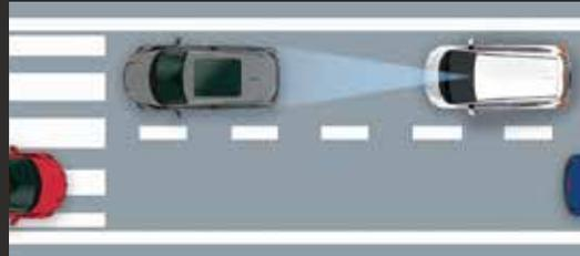
1: À une vitesse comprise entre 5 et 32 km/h en ville, ce système minimise les risques de collision en surveillant en permanence la distance qui vous sépare du véhicule précédent.
