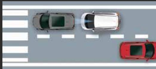
3: En l'absence de réaction de votre part et si la collision est imminente, le système peut appliquer automatiquement un freinage d'urgence pour ralentir au maximum le véhicule. Si les conditions sont favorables, il peut même éviter le choc.
